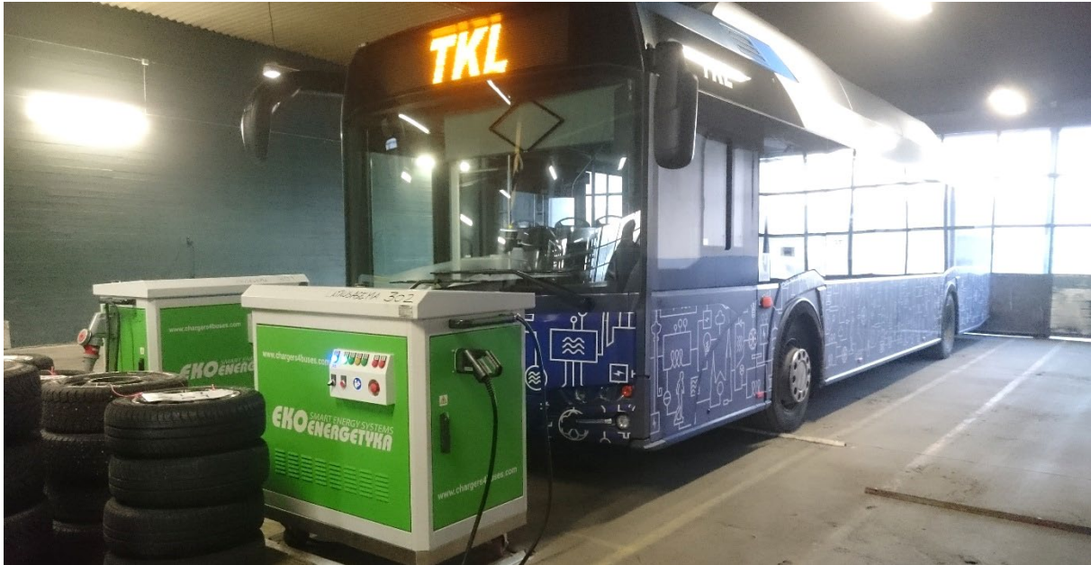
Kuva 11. Täyssähköbussi hidaslatauksessa Tampereella
