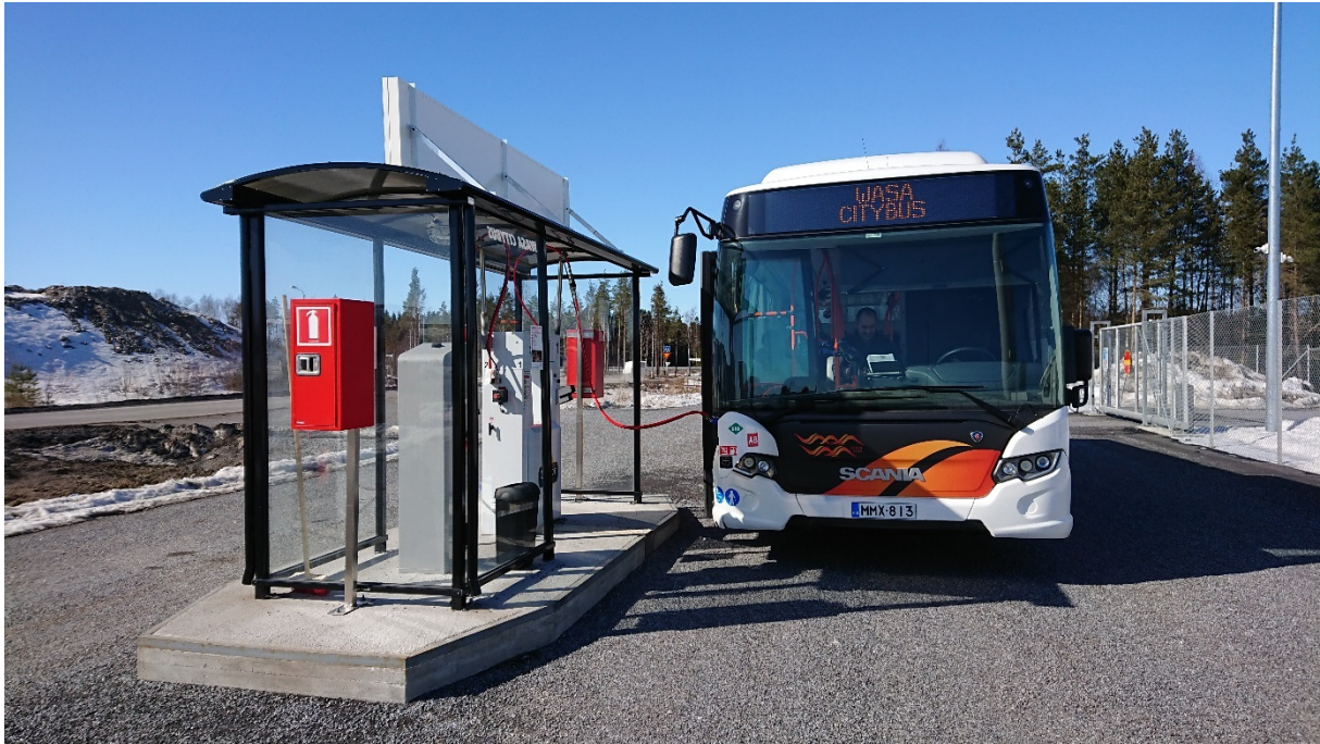
Kuva 7. Kaasubussi pikatankkauksessa kaasubussivarikolla
