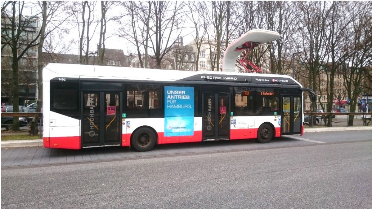
Kuva 15. Ladattava hybridibussi pikalatauksessa Saksan Hampurissa.
