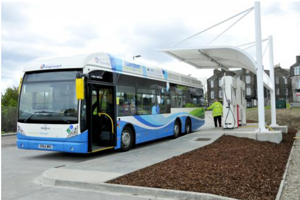
Kuva 18. Polttokennobussi tankkausasemalla Aberdeenissa Skotlannissa. (lähde: https://www.fuelcellbuses.eu ).
