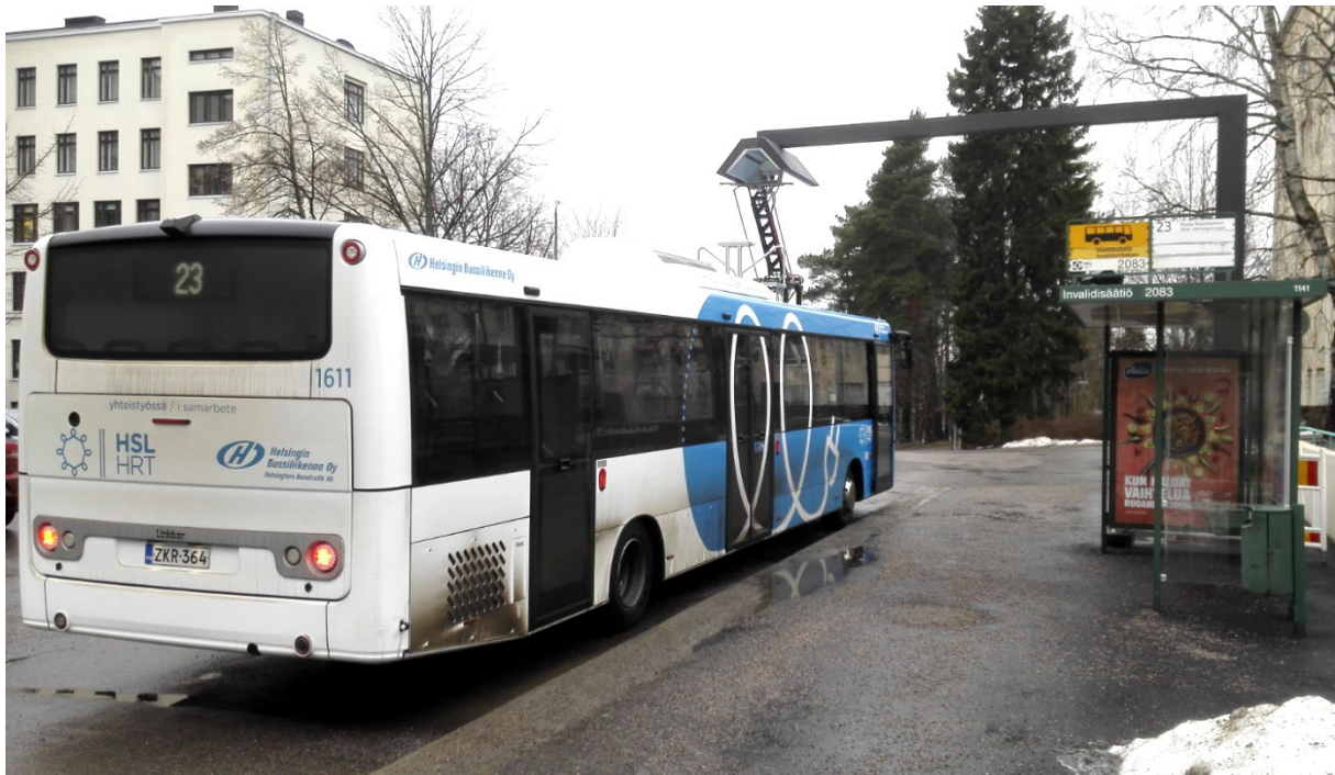
Kuva 10. Täyssähköbussi pikalatauksessa Helsingin Ruskeasuon pääte pysäkillä.
